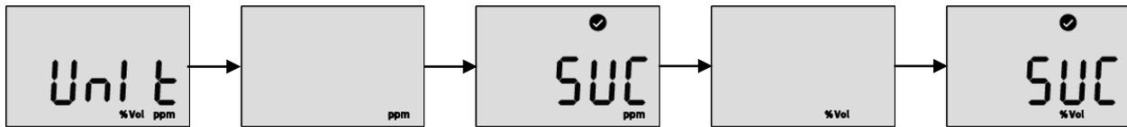
Um die Messeinheit (ppm oder %Vol.) im Gerät zu ändern, führen Sie die folgenden Schritte aus:
