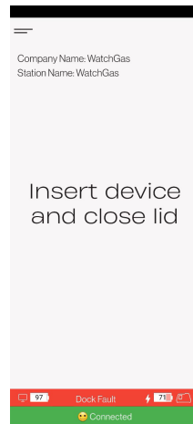
Pressione Dock Fault para remover a falha
