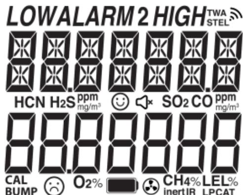
При включении или выключении устройства подсвечивается весь дисплей, как указано выше, и на нем отображаются все сегменты, подтверждая правильность его работы.
