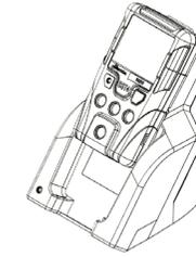
La gama de productos SST se puede cargar con el cargador universal de WatchGas.
