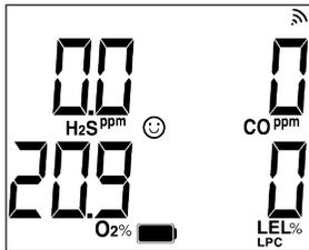
En funcionamiento normal, se muestran los sensores instalados y una carita sonriente indica que no se precisa atención. Oprime el botón durante 1.5 segundos hasta que escuches un pitido y el icono de NFC parpadee. Utiliza la aplicación de WatchGas SST o un SST Dock para configurar la unidad. Los detalles figuran en el manual.
