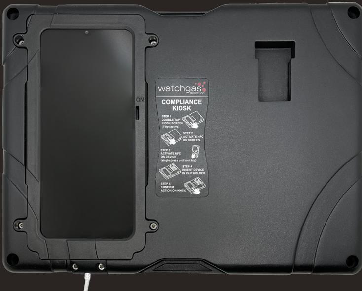
Der WatchGas Compliance Kiosk fungiert als ein Kontroll-Center, der es ermöglicht, sich beim Gaswarngerät anzumelden und eine umfassende Übersicht über den Gerätestatus zu erhalten. Der Compliance Kiosk sendet automatisch alle Daten an eine Software-Plattform. Dies bietet eine kosteneffiziente Übersicht über den Zustand der Geräte, anstehende Wartung, Ereignisse und Alarmer.
