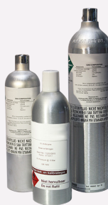
Gas de calibración
