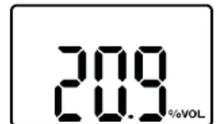
Cuando se activa, en modo de detección, la concentración de gas o tiempo de batería restante aparecen en la pantalla. La concentración de oxígeno se muestra en porcentaje por volumen (% VOL) y la concentración tóxica se muestran en partes por millón (ppm).
