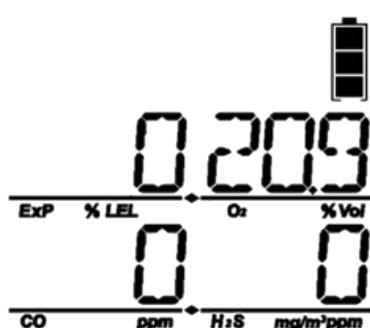
Pokud zařízení po stabilizaci přejde do normálního režimu měření, na LCD monitoru se zobrazí koncentrace plynu a úroveň nabití baterie. Kyslík je zobrazen v% obj., Hořlavé plyny v% LEL a H2S, CO v jednotce PPM. Když se úrovně koncentrace změní, hodnota se zobrazí v reálném čase a když úrovně překročí prahovou hodnotu pro LOW alarm nebo HIGH alarm (nebo TWA / STEL), ikony displeje LOW, HIGH, TWA nebo STEL pravidelně blikají a alarm, LED a vibrace se aktivují.
