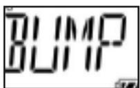
**ALARM „FÄLLIGER BUMP-TEST“:** Sounder: 1 Piepston/Min., LEDs: blinken 1 Mal/Min., Vibration: 1 Mal/Min., Display: es blinkt „**BUMP**“
