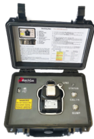
Estação de acoplamento único da série UNI
