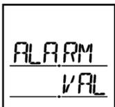
Compruebe manualmente los valores de ajuste (Alarma Bajo, Alto, TWA, STEL).
