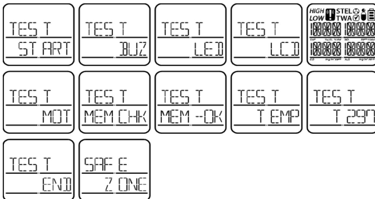
Mantenga pulsado el botón durante 3 segundos. El dispositivo iniciará la autopruueba comprobando el zumbador, LED, LCD, Motor, Memoria y Temperatura.
