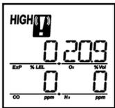
Una concentración de gas máxima detectada por el dispositivo.
