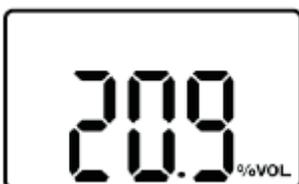
Lorsqu'il est activé, dans le mode de détection, la détection concentration de gaz ou la durée de vie restante de la batterie apparaît sur l'écran. La concentration d'oxygène est affichée en pourcentage en volume (%Vol) et la concentration toxique est affichée en parties par million (ppm).
