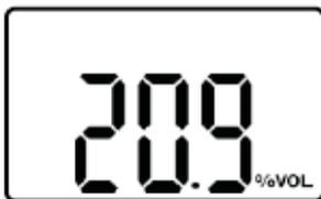
Cuando se activa, en modo de detección, la concentración de gas o tiempo de batería restante aparecen en la pantalla. La concentración de oxígeno se muestra en porcentaje por volumen (% VOL) y la concentración tóxica se muestran en partes por millón (ppm).
