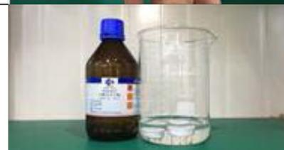
4. Mettez le bécher dans un bain de nettoyage à ultrasons et sonifiez pendant 5 minutes. Remplacez ensuite l'alcool par de l'eau distillée et soniquez pendant 2 minutes. Enfin, retirez le capteur et séchez-le. Si possible, utilisez un léger courant d'air propre pour souffler le liquide résiduel hors du capteur.
