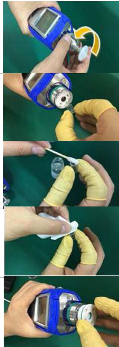
**Recalibrez toujours le PID après avoir nettoyé la lampe et/ou le capteur.**
