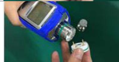
3. Mettez le capteur dans un bécher et couvrez-le de méthanol ou d'éthanol pur.
