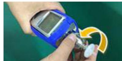
2. Tirez le capteur en ligne droite, en effectuant un léger mouvement de balancement si nécessaire.
