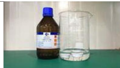
4. Ponga el vaso en un baño de limpieza ultrasónico y soníquelo durante 5 minutos. Luego reemplace el alcohol con agua destilada y sonique durante 2 minutos. Por último, sacar El sensor y secarlo. Si es posible, aplique una corriente suave de aire limpio para soplar el residuo líquido fuera del sensor.
