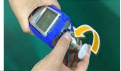
2. Póngase guantes y saque la lámpara. Inserte una nueva lámpara o limpie la lámpara existente como se describe a continuación.
