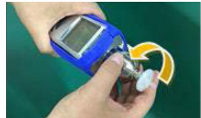
2. Tire del sensor hacia afuera, dando un movimiento ligero de ser necesario.
