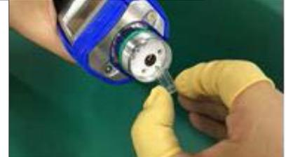
3. Use un hisopo de algodón humedecido con metanol para limpiar la superficie plana de la ventana de la lámpara. Si la suciedad con grasa es difícil de eliminar con metanol, la ventana se puede pulir utilizando pasta de pulido de alúmina fina.
